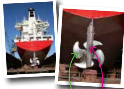
Viele Schiffe werden durch die Schiffsschraube vorwärts bewegt und mit dem Steuerruder gelenkt.
